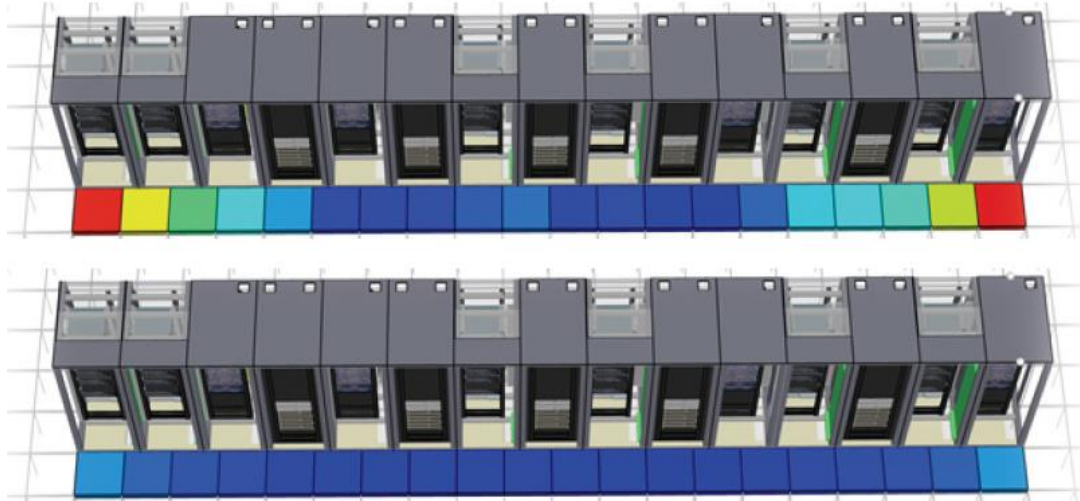
图 4 在最上面一行最末端铺砖上的红色、黄色和绿色表示较少流量，它们会影响机柜正常运行的时间。在底部，旧地板格栅已经更换，导致更好的气流——更多的冷空气在每行的最末端被用于机柜冷却
