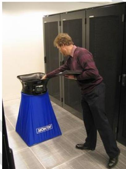
图 11 数据中心冷空气通道中使用的流量罩用于穿孔地板气流测量。
