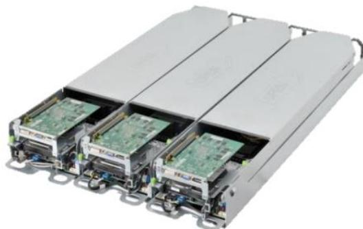
图 5：机架托盘中的服务器配置
